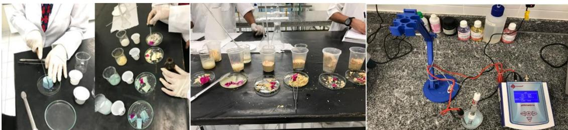
**Figura 4-** Testes dos produtos pela verificação do pH por fenolftaleína e pelo pHmetro
