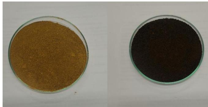
**Figura 2** – Trituração das biomassas da uva e do maracujá
