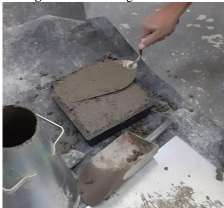
Figura 03 – Moldagem dos blocos
