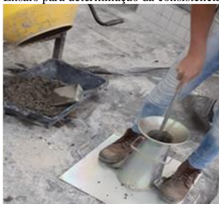
Figura 02 - Ensaio para determinação da consistência do concreto.
